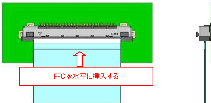
図. 2-3 FFC 挿入方法 2
