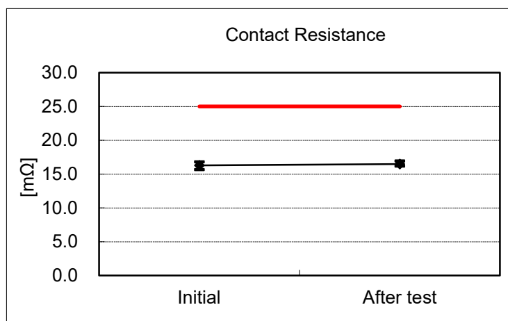
グラフ-5.高温試験
