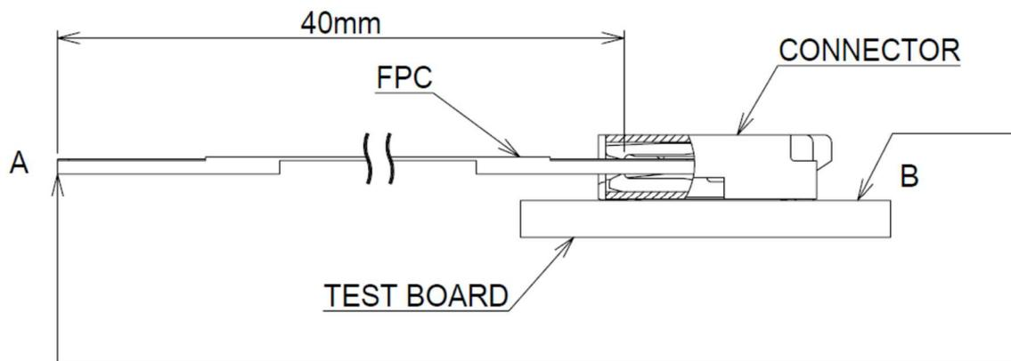
$$\text{接触抵抗} = R_{AB} - \text{FPC40mm 分} - \text{Test Board 分の抵抗}$$
