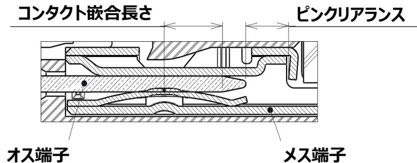
図 3.コンタクト嵌合長さ・ピンクリアランス
