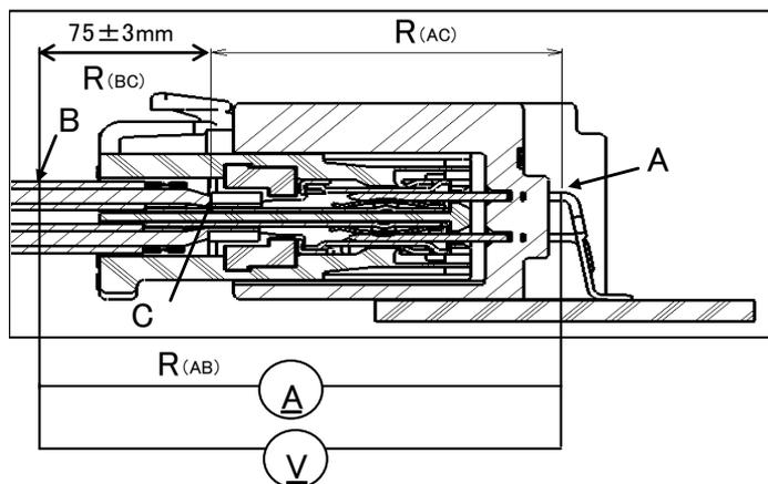
図 2. 接続回路及び測定位置
