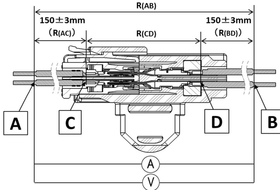
図 2. 接続回路及び測定位置
