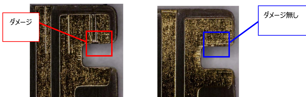
図 24.(a) アクチュエータークローズ状態で抜去した場合(b) 正常抜去した場合
