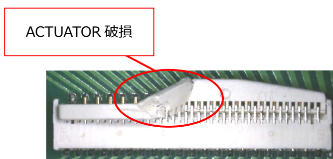
写真 6. ACTUATOR 破損 (NG)
