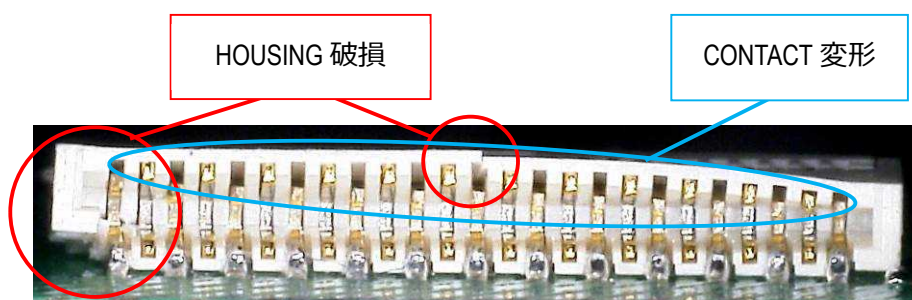
写真 7. HOUSING 破損及び CONTACT の変形 (NG)
