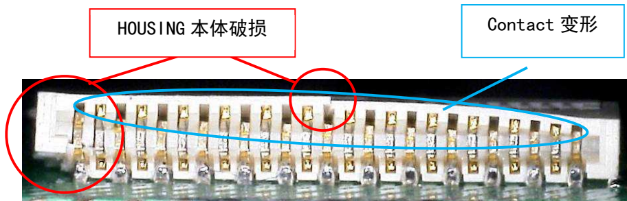
照片 7. HOUSING 本体破损以及 Contact 变形 (NG)
