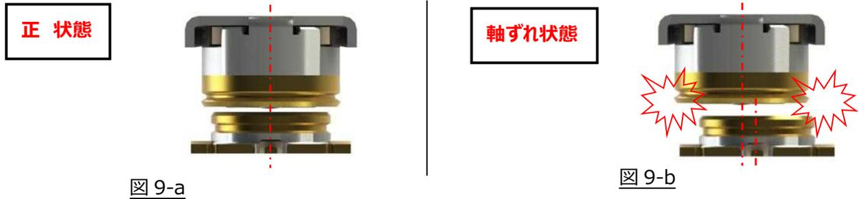
嵌合時は図. 10-a のように必ずケーブル側コネクタと基板が平行状態で垂直に嵌合してください。
