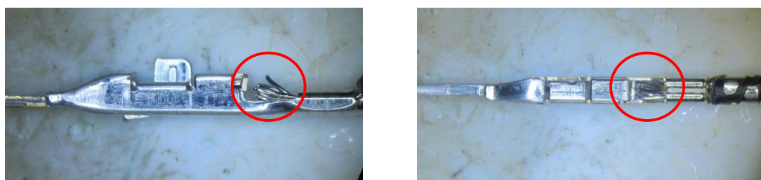
図 19 芯線飛び出し過多状態
