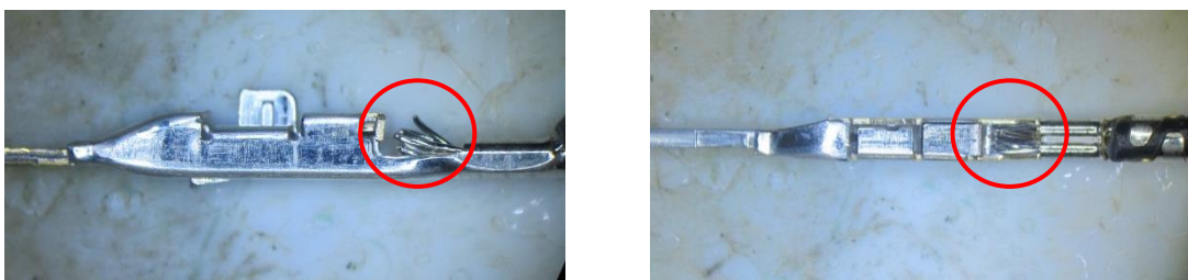
図 19 芯線飛び出し過多状態
