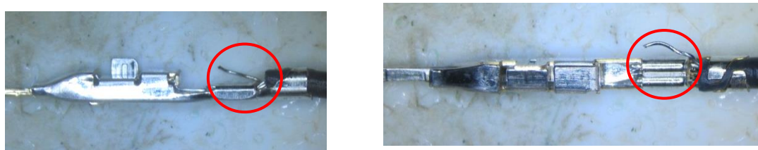
図 20.芯線はみ出し状態
