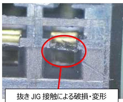
図 42. 抜き JIG 接触による破損・変形
