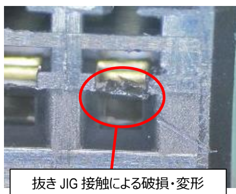
図 41. 抜き JIG 接触による破損・変形
