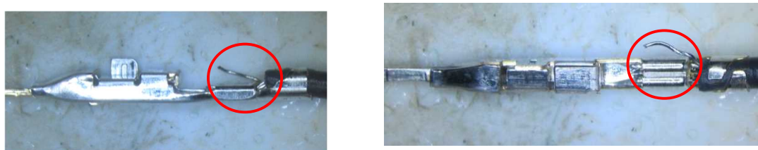
図 20.芯線はみ出し状態
