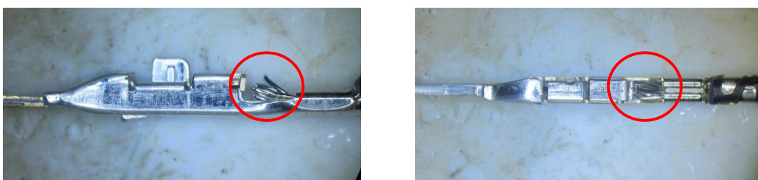
図 19 芯線飛び出し過多状態
