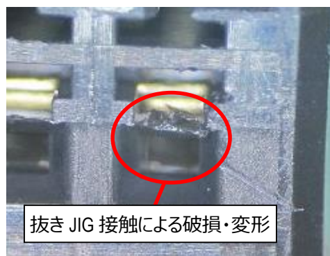
図 35. 抜き JIG 接触による破損・変形
