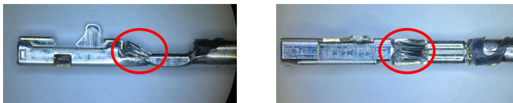
図 19 芯線飛び出し過多状態
