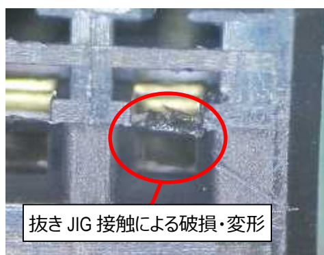
図 36. 抜き JIG 接触による破損・変形
