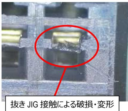
図 41 抜き JIG 接触による破損・変形
