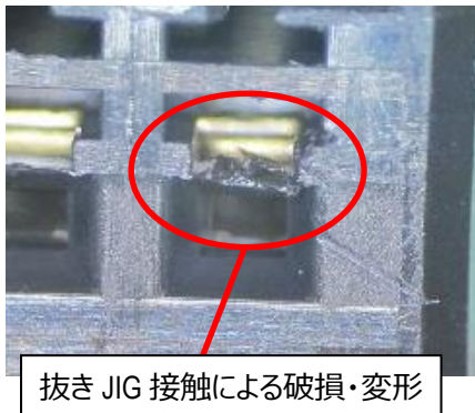
図 41 抜き JIG 接触による破損・変形
