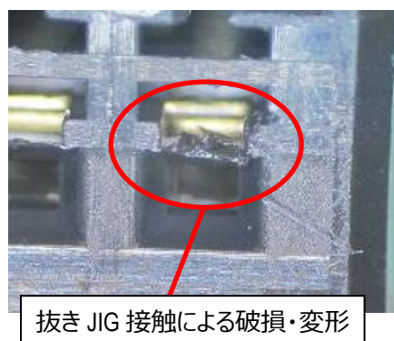
図 41 抜き JIG 接触による破損・変形
