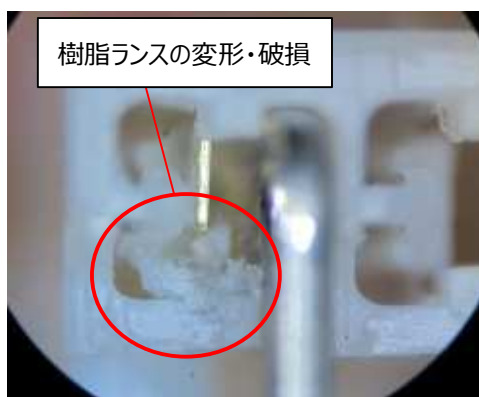
図.31 端子抜き JIG 接触による破損・変形
