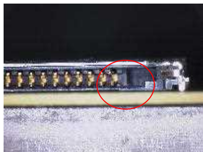
基板側コネクタ端子変形
