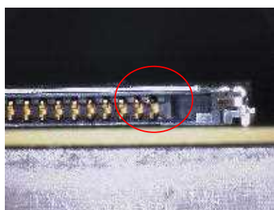
基板側コネクタ端子変形
