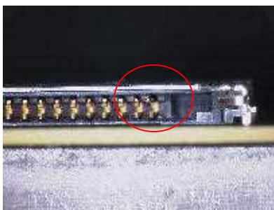
基板側コネクタ端子変形
