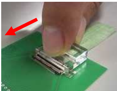
平行挿入 OK 状態 / Parallel insert OK
