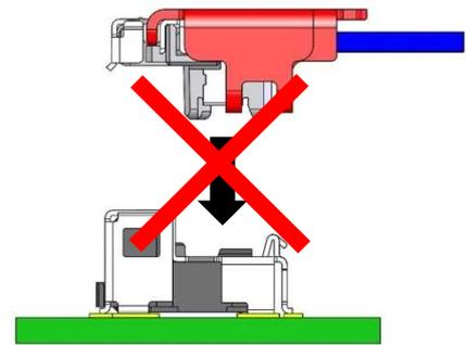
· 如图 4、5 所示，安装时要确保 Plug 在基板的丝印“[ ]”内。
