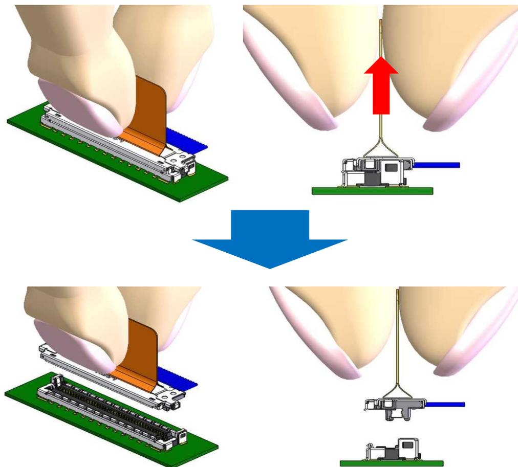
Fig.26 利用 PULL TAPE 拔出的方法
