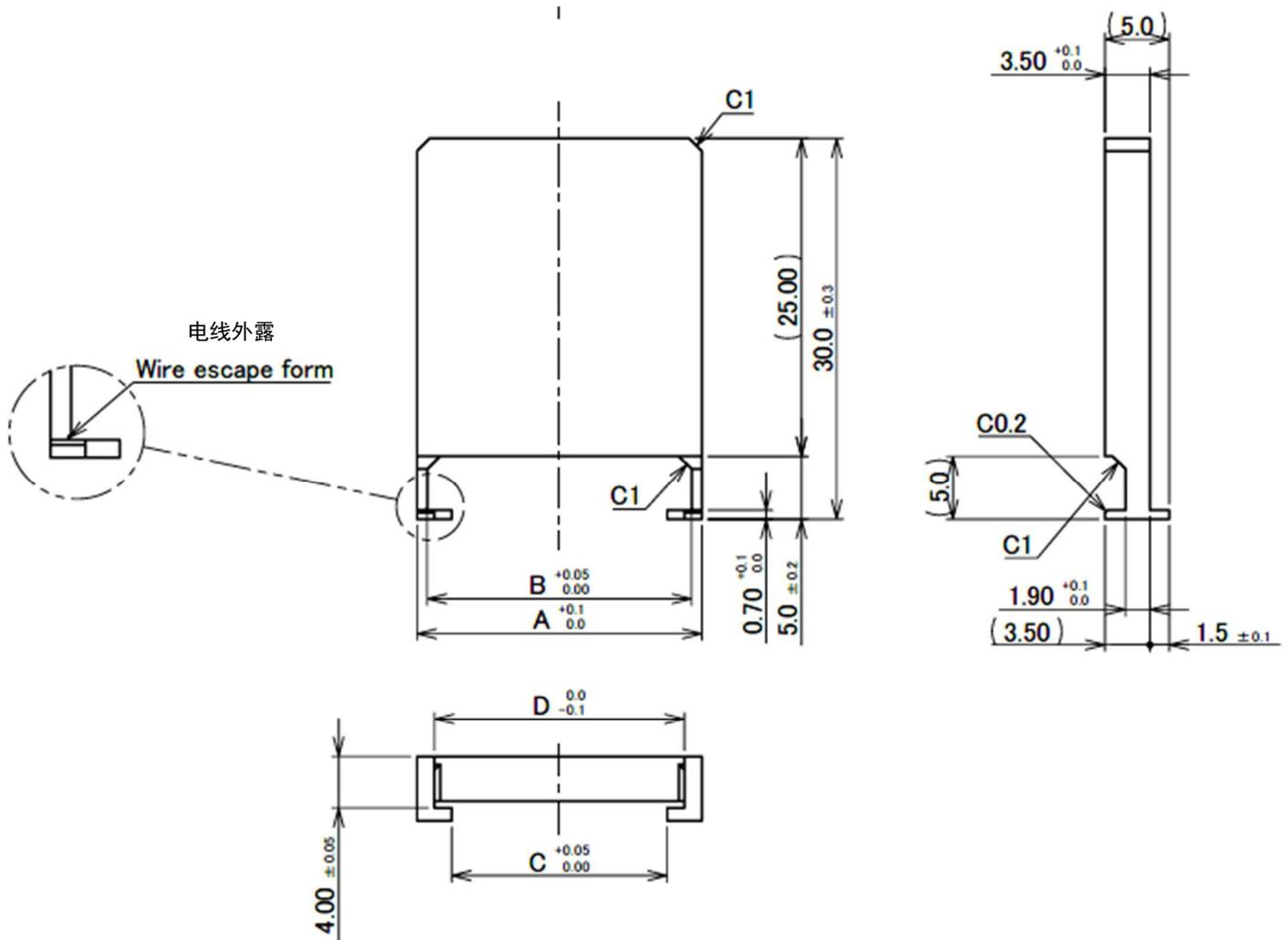
Fig.20 参考 拔出 JIG
