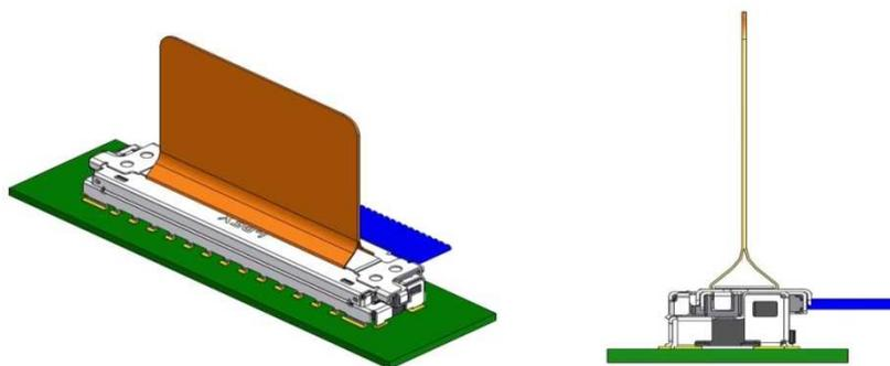
Fig.25 有 PULL TAPE 的嵌合状态
