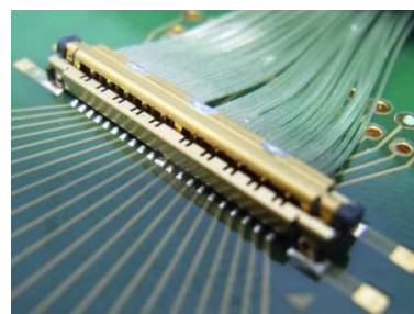
Fig.4 セット方法 Correct Connector Mating View
