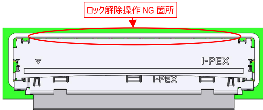
図 20 ロック解除 NG 操作箇所
