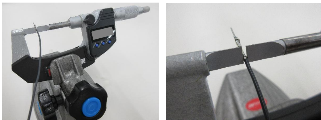
図/ Fig 8.インシュレーションバレルクリンプワイド測定方法/ Insulation barrel crimp width measurement
