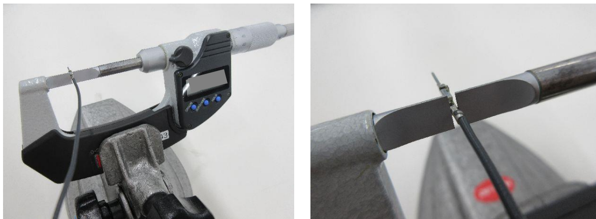
図/ Fig 7.ワイヤバレルクリンプワイド測定方法/ Wire barrelCrimp width measurement
