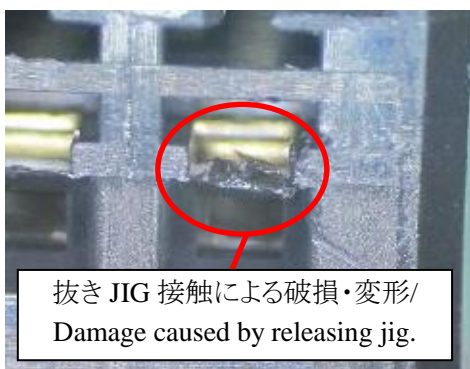
抜き JIG 接触による破損・変形
