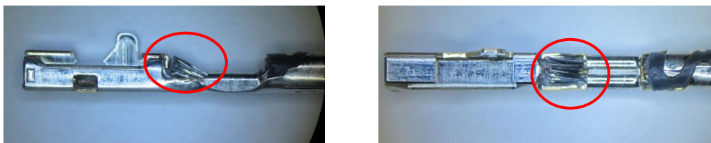
図 17 芯線飛び出し過多状態
