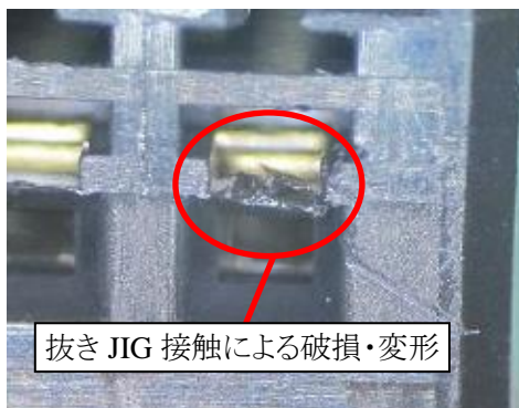
図 34. 抜き JIG 接触による破損・変形
