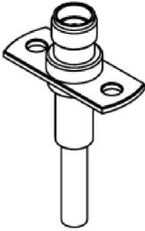
MHF-SW23 RECEPTACLE HIGH CYCLE SMA ADAPTER
