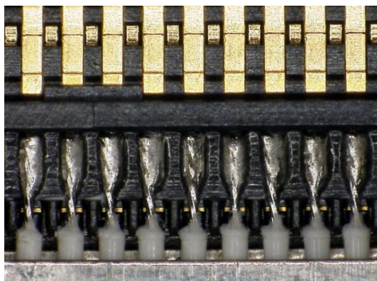
写真 3 . AWG#40 半田付け状態
