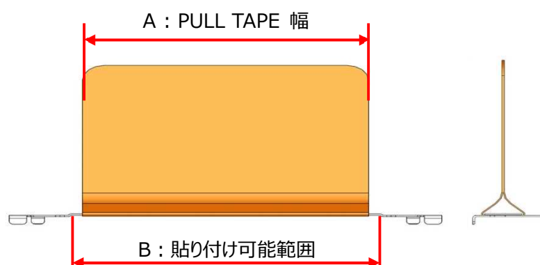
図.9 PULL TAPE 寸法
