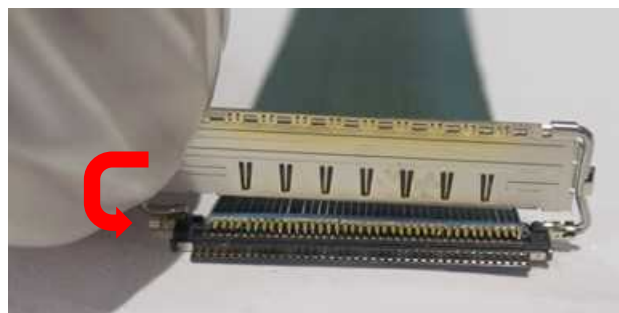
图片 12 锁杆配件组装
