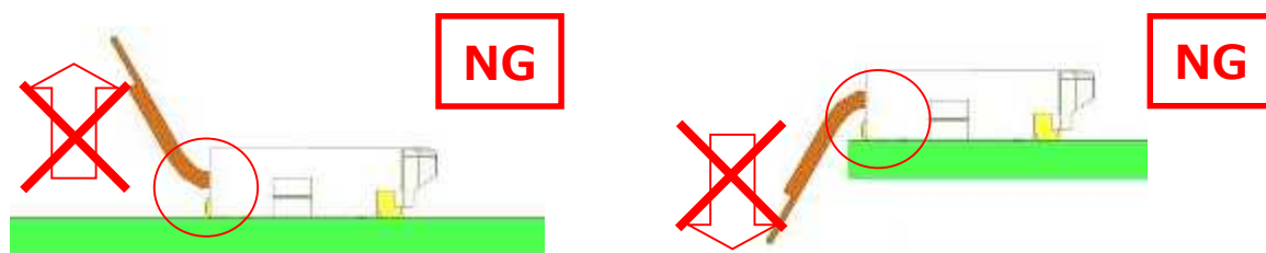
図 22. FPC の屈曲 (NG) / Fig.22 Flexion of FPC (NG)
