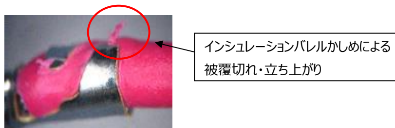
図 24.被覆切れ状態
