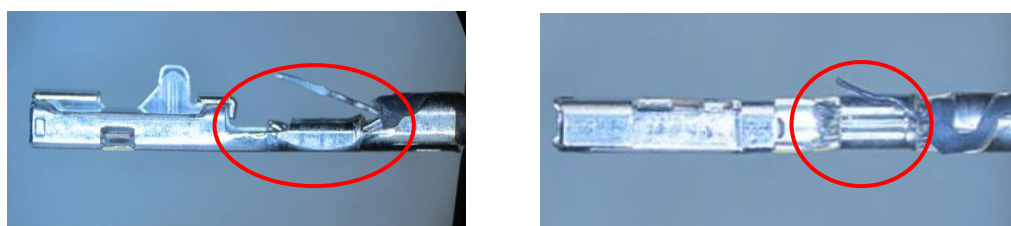
図 20.芯線はみ出し状態
