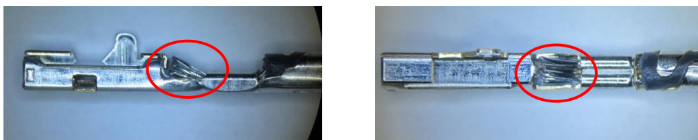
図 19 芯線飛び出し過多状態
