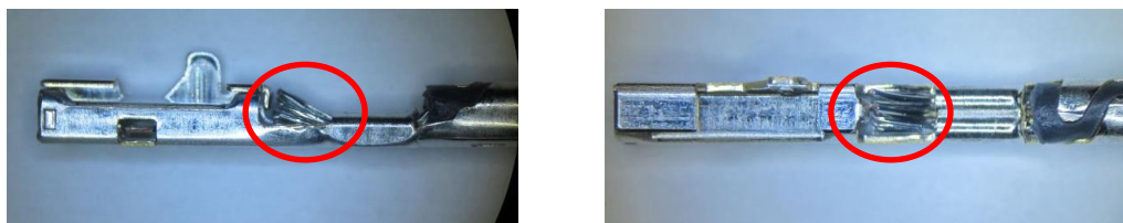
図 19 芯線飛び出し過多状態
