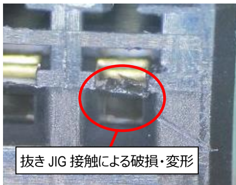
図 36. 抜き JIG 接触による破損・変形
